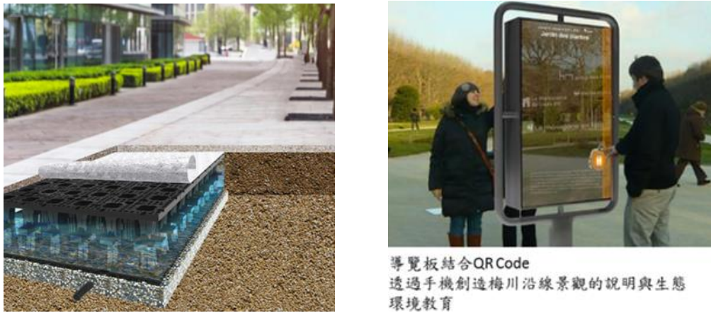
圖 39 透水鋪面及環境教育解說平台示意圖
